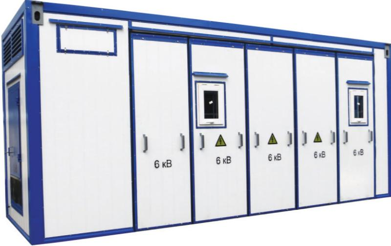
ВПЧ в климатическом исполнении УХЛ1 предназначен для частотного пуска и регулирования скорости вращения асинхронных и синхронных электродвигателей мощностью от 250 кВт до 2000 кВт, с номинальным напряжением 6 кВ, и мощностью от 400 кВт до 800 кВт, с номинальным напряжением 10 кВ.
